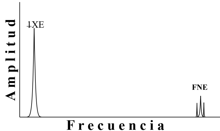
Gráfica espectral indicando diente de engrane fisurado o fracturado.
