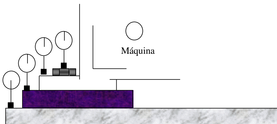
Comportamiento de la fase con la presencia de aflojamiento estructural y/o aflojamiento en los pedestales.
