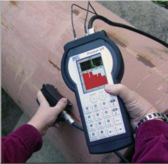
Figura 13. Tubería analizada por ultrasonido
