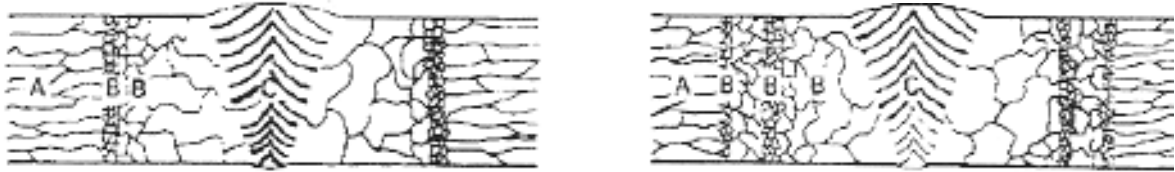
Figura 4.26 - Zonas afectadas térmicamente con granos recristalizados
