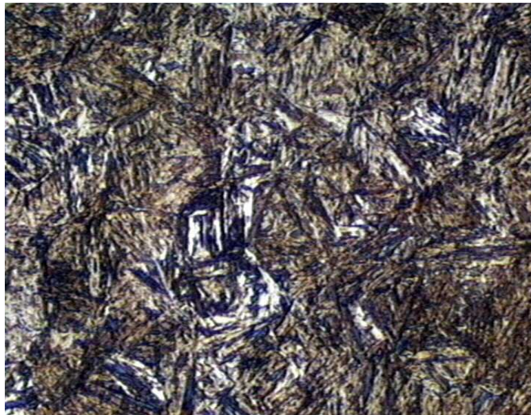
Figura 4.23 - Martensita sin revenir. Ataque: Picral 2%, 400X
