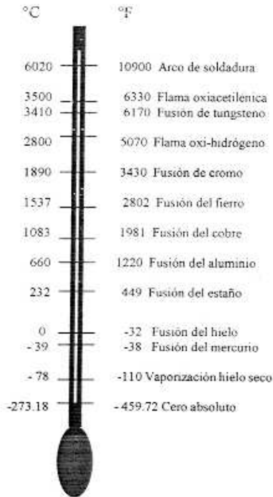
Figura 5.5 - Algunas temperaturas de interés para la soldadura
