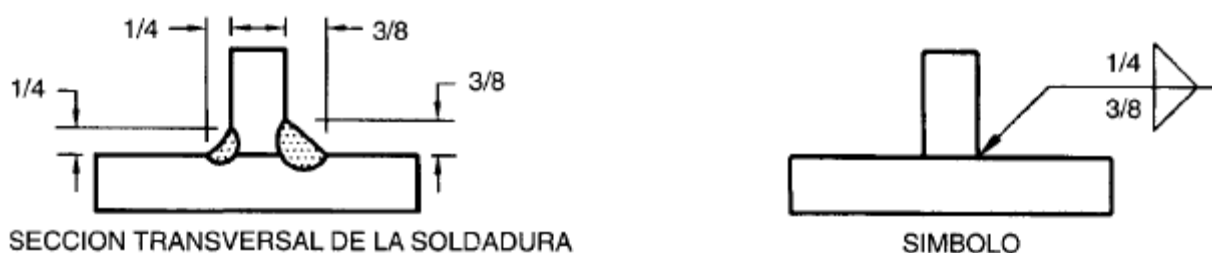
Figura 3.13 – Soldadura de Filete por Ambos Lados
