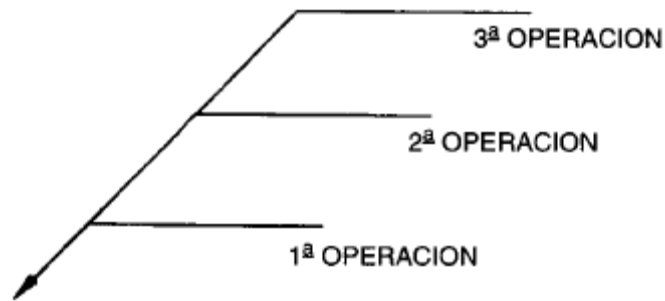
Figura 3.11 – Símbolo de Soldar con Líneas de Referencia Múltiples
