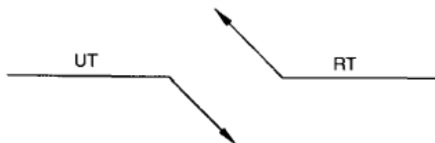
Figura 3.27 – Aplicación del Símbolo de Ensayo No Destructivo a Aplicar por el Lado Opuesto a la Flecha
