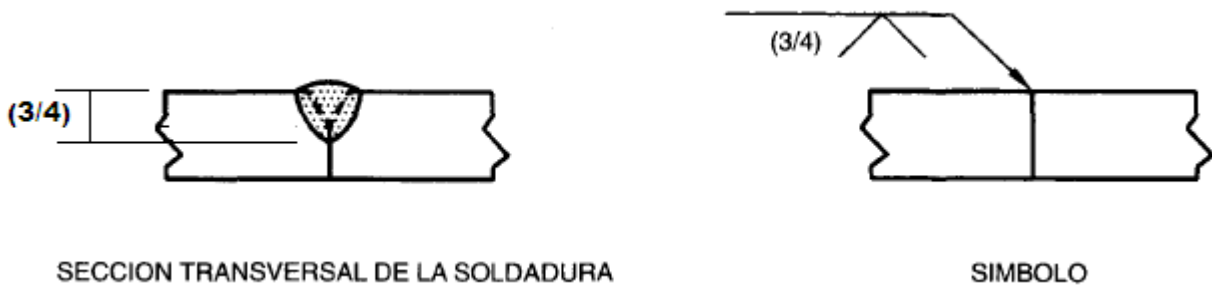
Figura 3.20 – Designación de Garganta Efectiva sin Especificar Profundidad
