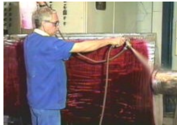
Fotografía N° 5: Remoción de penetrante con agua pulverizada (Spray)
