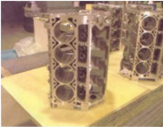
Fotografía N° 1: Inspección del bloque del motor – Fase de limpieza
