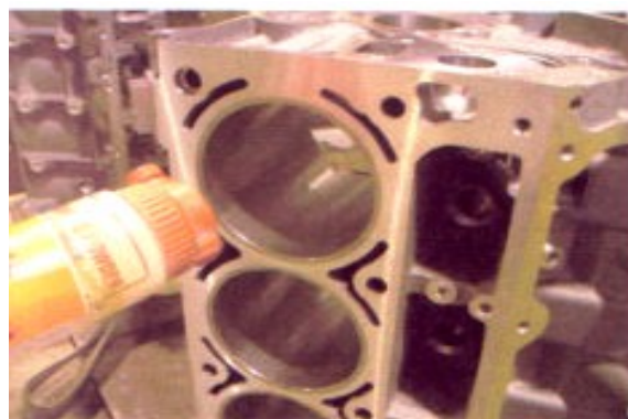
Fotografía N° 7: Aplicación de revelador seco con pulverizador manual (aerosol)
