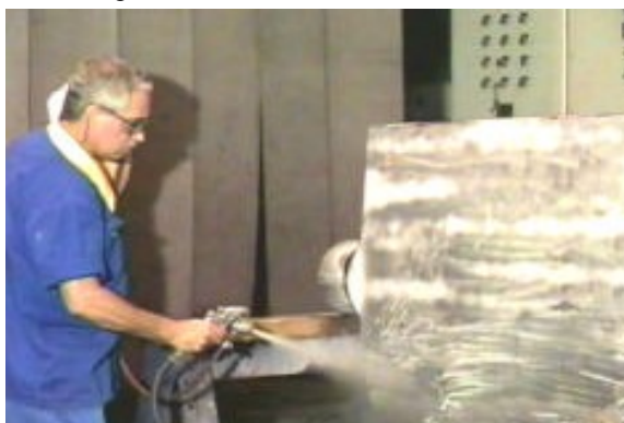
Fotografía N° 6: Aplicación de revelador por pulverización con pistola de pintura
