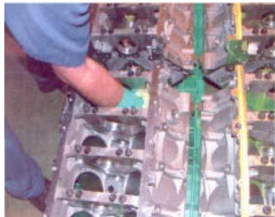
Fotografía N° 2: Aplicación de penetrante con brocha
