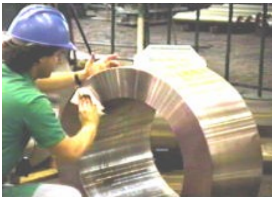
Fotografía N° 4: Remoción de penetrante con paño
